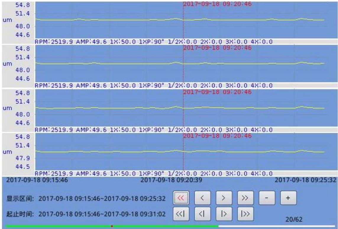
其中“《”和“》”分别为向左向右移动整屏幕数据量；“<”和“>”分别为向左向右移动1/8屏幕的数据量；“-”和“+”分别为缩小和放大显示曲线；“《|”和“|》”分别为移动1/8屏幕的红色光标；“<|”和“|>”分别为将红色光标移动到下一个数据点；
